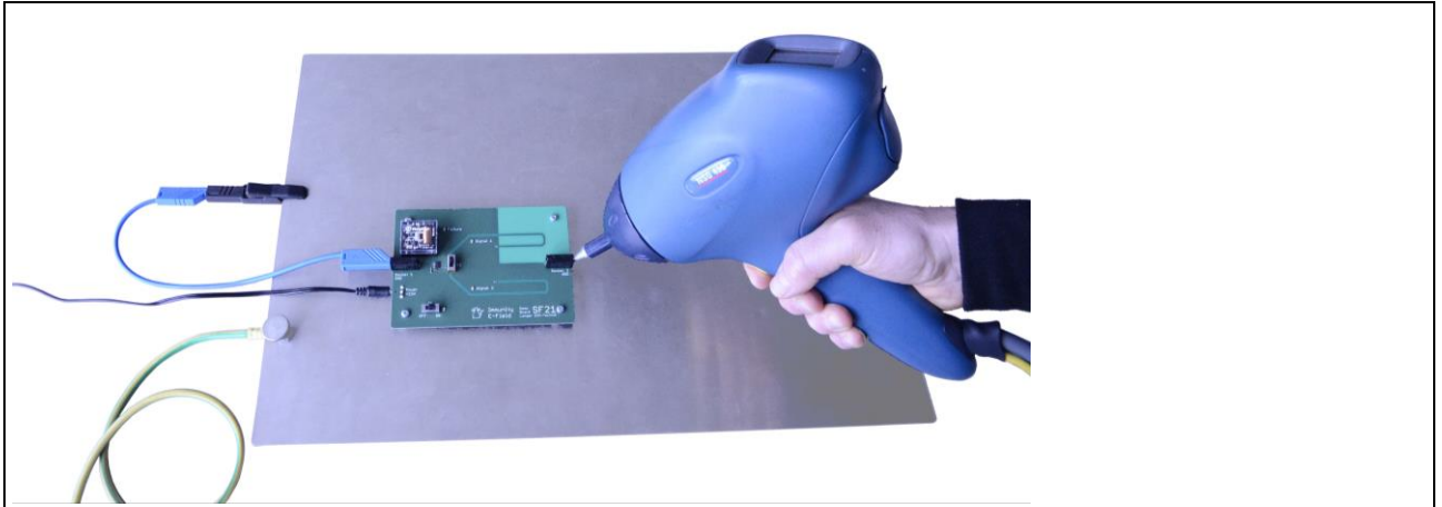
Bild 23: Versuche mit ESD-Generator über einer Metallfläche
